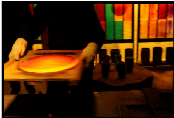
Fig.12 : Un mouvement rapide emmène la dalle de verre vers le four de recuisson
