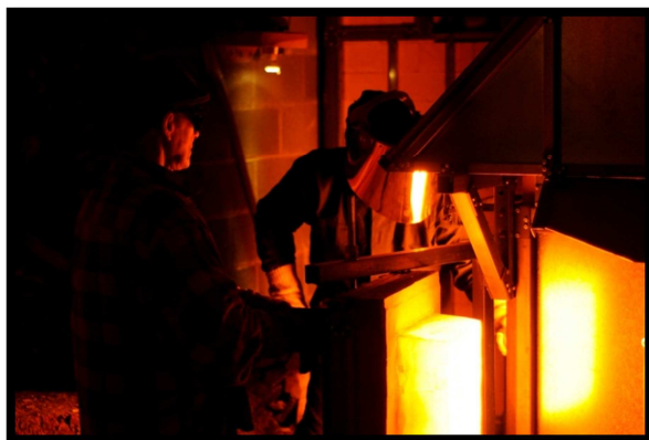
Fig.7 : Le creuset est ensuite renfourné afin de le réutiliser dans une étape ultérieure
