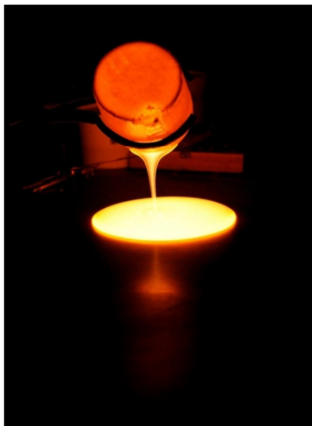
Fig.5 : La viscosité du verre est telle que le creuset se vide de plus en plus lentement
