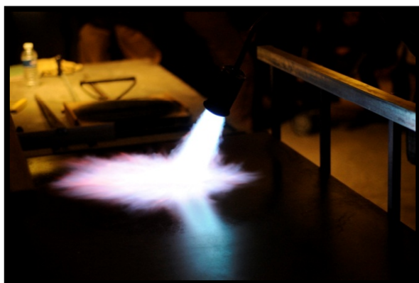
Fig.1 : Chauffage de la table en fonte afin d'éviter que le verre ne colle au moment du contact
