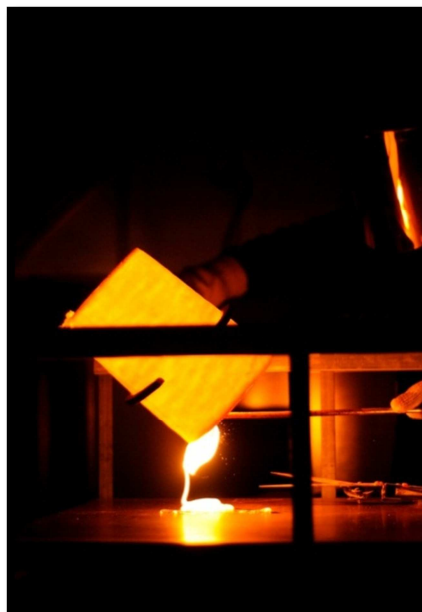
Fig.6 : Un racloir s'impose pour ôter les dernières gouttes de verre
