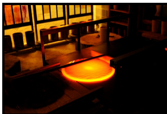
Fig.10 : Une pelle attire la dalle de verre encore incandescente vers l'extrémité de la table
