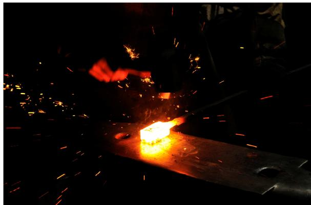
Fig.4 : Alternance de mise au feu et frappe à la masse sur l'enclume, inlassablement
