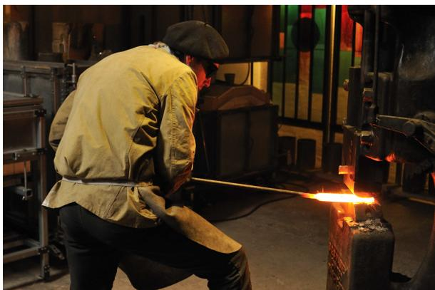
Fig.7 : Martelage et extrusion de la lame naissante
