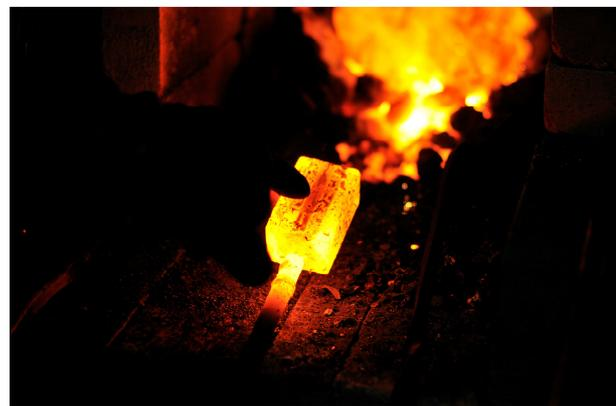
Fig.2 : Les couches alternées se soudent sous l'effet combiné de chaleur et de pression
